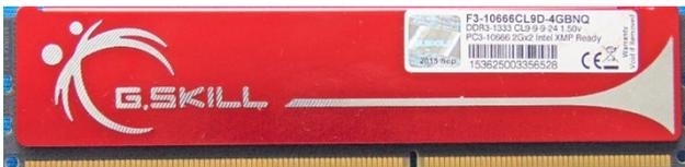
DDR3-Speicherriegel mit Kühlkörper
