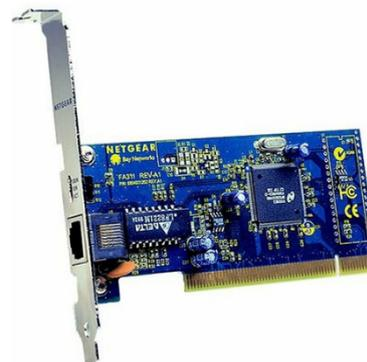
Netzkarte mit RJ45-Anschluss zum Einbau in ein PC-Gehäuse
