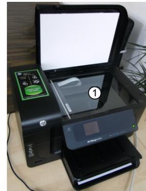
Nach dem Start des Scanvorgangs wird der Sensor unter der Glasplatte an der gesamten Vorlage vorbeigefahren und führt die Abtastung durch. Flachbettscanner sind sehr preiswert, lassen sich einfach per USB anschließen und liefern gute Scanergebnisse. Sie haben deshalb im Heim- und Bürobereich weite Verbreitung gefunden.
