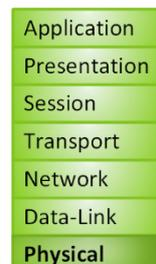
Die **funktionalen** Spezifikationen befassen sich mit der Funktion von Verbindungen, wie z. B. der Unterscheidung Datenleitung – Steuerungsleitung, der Taktgebung oder der Pin-Belegung.
