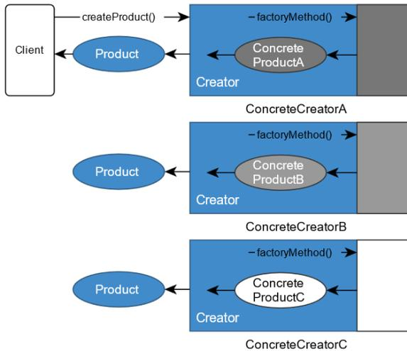
Das Factory Method Entwurfsmuster dient der Entkopplung des Clients von der konkreten Instanziierung einer Klasse. Das erstellte Objekt kann elegant ausgetauscht werden.
