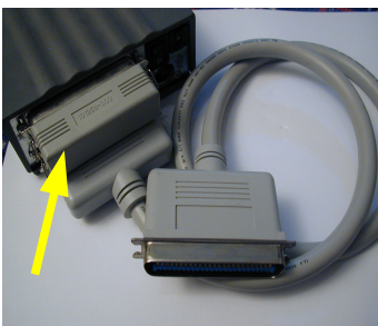
Abbildung 7.4: SCSII-Gerät mit Abschlusswiderstand (siehe Pfeil)
