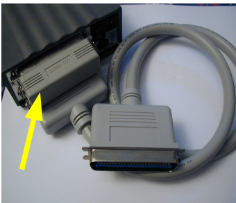
Abbildung 7.4: SCSII-Gerät mit Abschlusswiderstand (siehe Pfeil)
